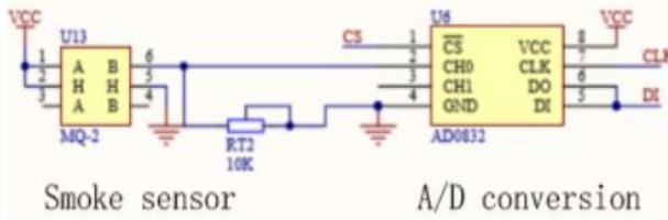
Fig.6.2. MQ-2 wiring diagram
